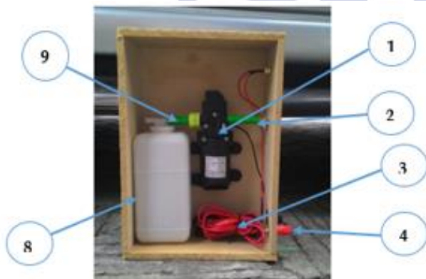
Gambar 2. Desain Rancang Bangun Alat Bleeding Rem Sistem Tertutup Pada Mobil Tampak Depan
