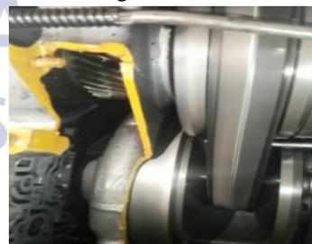
Gambar 13. transmisi cvt pada posisi N
