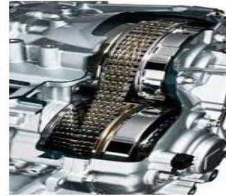
Gambar 4. Desain cutting transmisi otomatis tipe CVT
