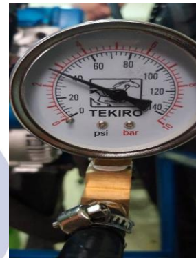
Gambar 12. Proses Uji Coba Tekanan Fuel Pump Menggunakan Pressure Gauge Minyak Kapasitas 10 kg.
