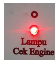
Gambar 13. lampu cek engine menyala ketika ada trouble pada sensor
