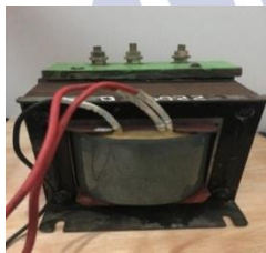
Gambar 3.3 Transformator (Sumber : Dokumentasi)
