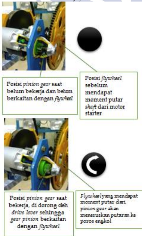
Gambar 6. Cara Kerja Pinion Gear
