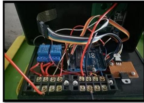
Gambar 6. Rangkaian *Hardware* Sistem Kontrol Mesin Pengisi jamu
