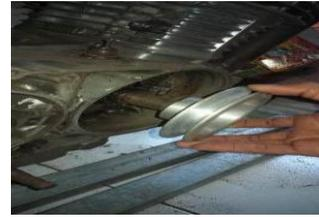
Gambar 5 Proses Pemasangan *pulley* dan *v – belt*
