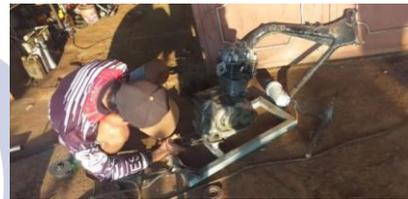
Gambar 6 Proses Pemasangan mesin sepeda motor
