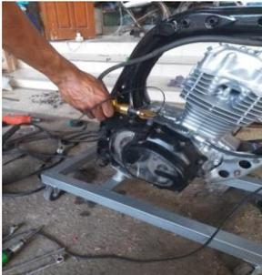
Gambar 12 proses pemasangan kabel kopling pada mesin 125cc
