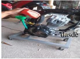
Gambar 9 Proses Pengisian Oli pada mesin sepeda motor
