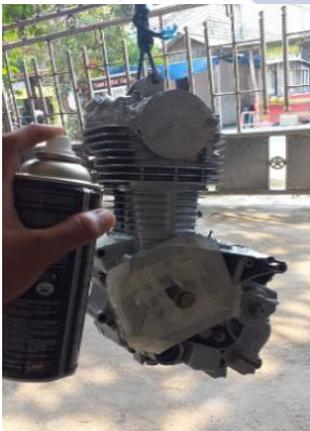
Gambar 4 Proses Pengecatan Mesin Sepeda Motor
