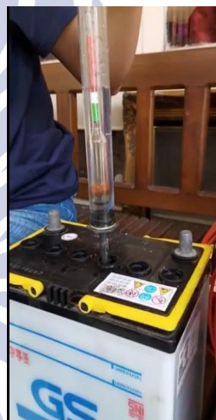
Gambar 8. Pengecekan Air aki Dengan Hydrometer
