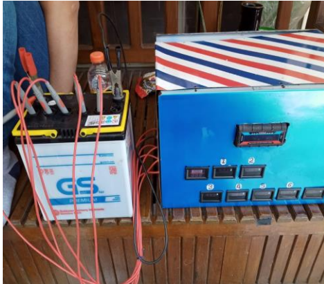
Gambar 9. Penataan Jarum Avometer Pada Lubang Aki
