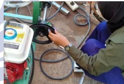
Gambar 6. Pemasangan Pulley
