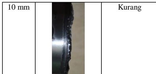
Dapat dilihat bahwa jarak pemotongan 7 mm mempunyai rata-rata bentuk pemotongan yang lebih rapi disetiap spesimen daripada jarak pemotongan yang lain. Ini menjadikan jarak pemotongan 7 mm dapat dibuat acuan untuk pemotongan menggunakan alat pemotong benda silindris berbasis oxy-acetylene.
