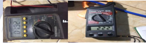
Gambar 29. Hasil pengujian tegangan sekunder dan arus sekunder (16 mm / 3 lilitan / 5 sekon)
