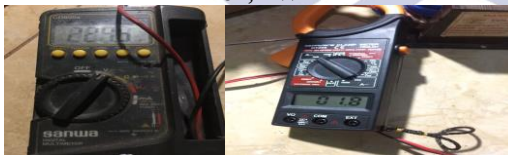
Gambar 16. Hasil pengujian tegangan primer dan arus primer (12 mm / 2 lilitan / 5 sekon)
