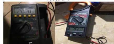
Gambar 22. Hasil pengujian tegangan primer dan arus primer (16 mm / 2 lilitan / 3 sekon)
