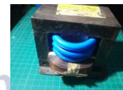
Gambar 12. Luas Penampang Lilitan Sekunder pada Trafo MOT (Microwave Oven Transformator) sesudah diberi lilitan
