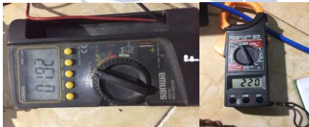
Gambar 25. Hasil pengujian tegangan sekunder dan arus sekunder (16 mm / 2 lilitan / 5 sekon)
