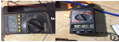
Gambar 23. Hasil pengujian tegangan sekunder dan arus sekunder (16 mm / 2 lilitan / 3 sekon)
