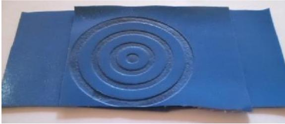
Gambar 7. Hasil pengepressan pada kain sintetis
