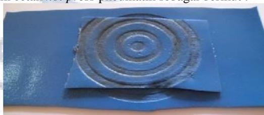
Gambar 6. Hasil pengepressan pada kain sintetis
