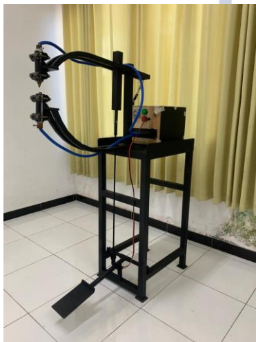
Gambar 8: Mesin Spot Welding Menggunakan Double Trafo
