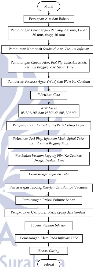
Gambar 9 Flowchart Proses Pembuatan Komposit Sandwich
