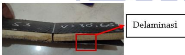
Gambar 19 Kegagalan Bending Delaminasi
