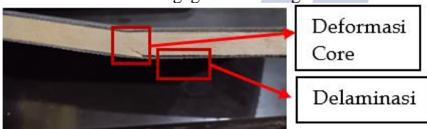
Gambar 18 Kegagalan Bending Core Retak Dan Delaminasi
