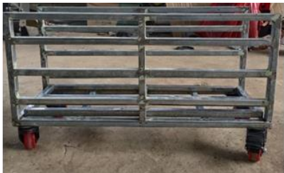
Gambar 9. Assembly Kerangka Timbangan Sensorik
