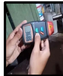
Gambar 10. Pengujian dengan kecepatan putaran 368 rpm
