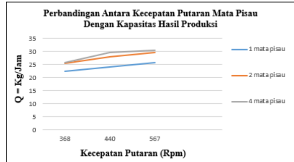
Gambar 12. Perbandingan Antara Kecepatan Putaran Mata Pisau Dengan Kapasitas Hasil Produksi
