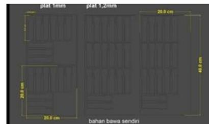
Gambar 5. Pemotongan Plat Spesimen dengan CNC
