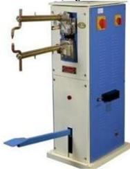
Gambar 2. Mesin las titik (*spot welding*) (Auki, 2022).
