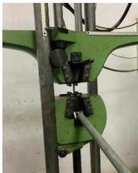
Gambar 7. Mesin Uji Tarik
