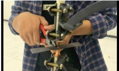
Gambar 6. Proses pengelasan dengan las titik (*spot welding*)
