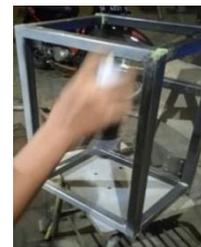
Gambar 4. Pengecatan Rangka
