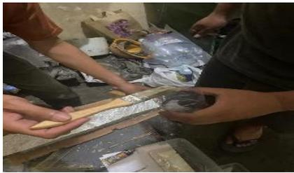
**Gambar 8.** Pengolesan Resin Dan FiberGlass
