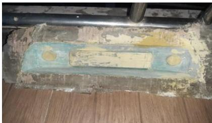
**Gambar 10.** Pelepasan Moulding Negatif Dan Moulding Positif
