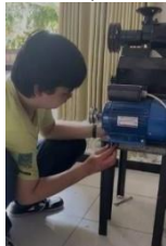
Gambar 5. Pemasangan Motor Penggerak
