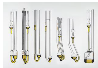
Gambar 1. Viskometer Ostwald. (Sumber: http://Penentuan Viskositas Cairan dengan alat viskometer oswald-KIMIATIP htm )
