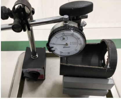
Gambar 7. Pengukuran Dial Indicator pada Intake Manifold dengan Kecepatan 100 mm/s
