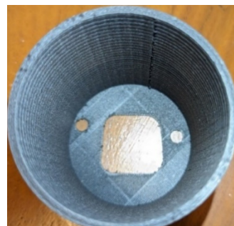
Gambar 6. Visual Produk Intake Manifold dengan Kecepatan 100 mm/s
