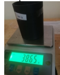
Gambar 5. Berat Produk Intake Manifold dengan Kecepatan 100 mm/s
