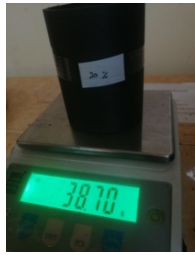
Gambar 13. Berat Produk Intake Manifold dengan Kecepatan 20 mm/s
