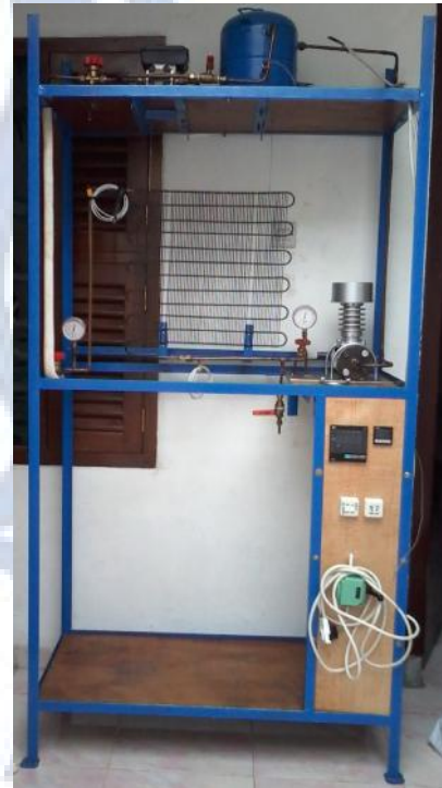
Gambar 6. Rancang Bangun Alat Penguji Efisiensi Penukar Panas Jenis Pembuluh dan Kawat
