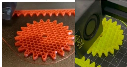
Gambar 9. Bentuk Pola Infill Pattern: I) Honeycomb, II) Cubic
