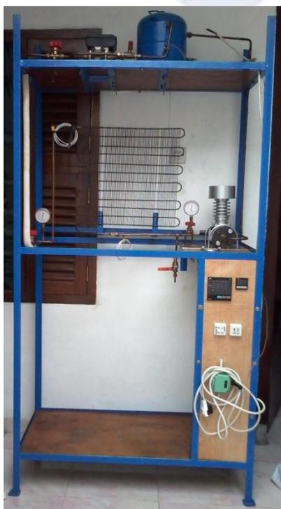
Gambar 3. Rancang Bangun Alat Penguji Efisiensi *Wire And Tube Heat Exchanger* Secara Utuh.
