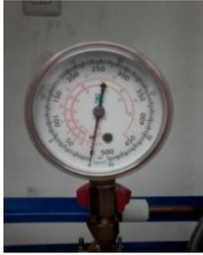
Gambar 5. *Pressure gauge* yang sudah terpasang
