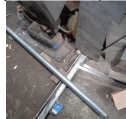
Gambar 6. Proses pembuatan poros screw
