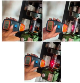
Gambar 9. Proses pengujian kecepatan putaran
