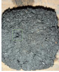
Gambar 14. Hasil dari proses pembriketan variasi pulley 2 inci
