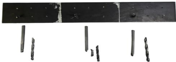
Hasil pengujian pengeboran material baja ST 37 menggunakan mata bor kobalt
