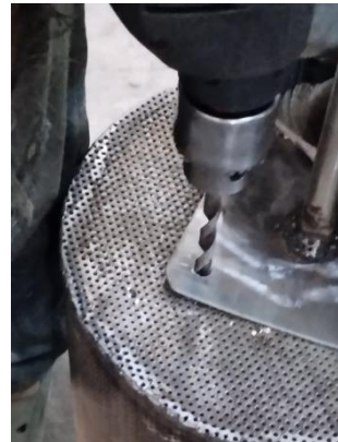
Gambar 8. Proses Pengeboran Plat Dudukan Saringan Sumber : (Dokumen Pribadi)
