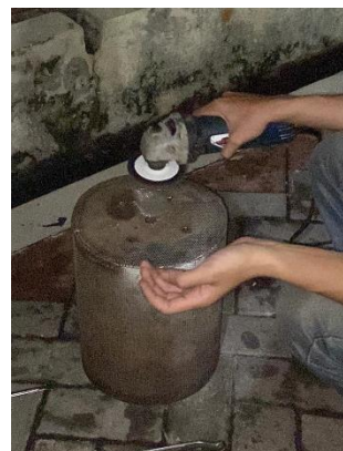
Gambar 9. Proses Finishing Saringan Sumber : (Dokumen Pribadi)
