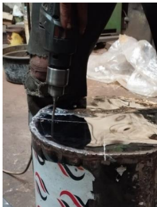
Gambar 5. Proses Pengeboran Tabung Luar Sumber : (Dokumen Pribadi)
