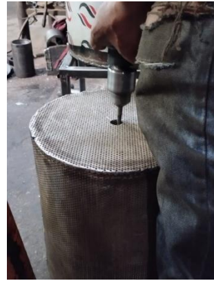
Gambar 7. Proses Pengeboran Saringan Sumber : (Dokumen Pribadi)
