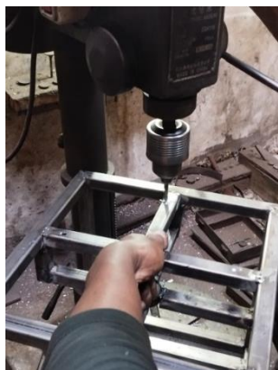
Gambar 6. Proses Pengeboran Rangka Sumber : (Dokumen Pribadi)
