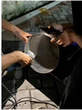
Gambar 10. Proses Finishing Tabung Luar Sumber : (Dokumen Pribadi)
