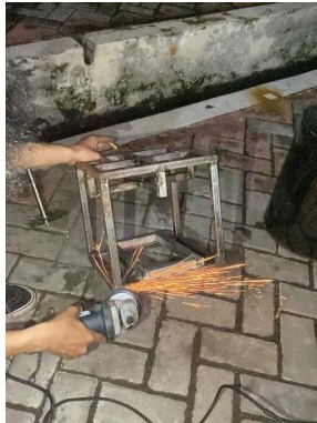
Gambar 11. Proses Finishing Rangka Sumber : (Dokumen Pribadi)
