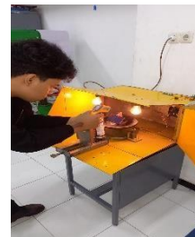
Gambar 7. Pengukuran Suhu Menggunakan Thermometer
