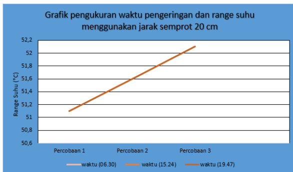
Gambar 9. Grafik Pengukuran waktu pengeringan dan range suhu menggunakan jarak 20 cm
