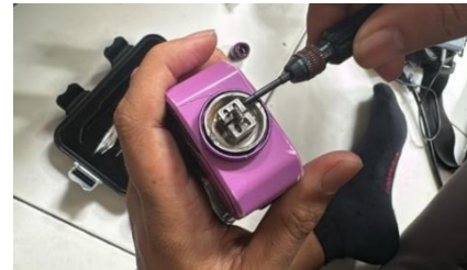
Gambar 2. Pemasangan hasil lilitan coil pada atomizer
