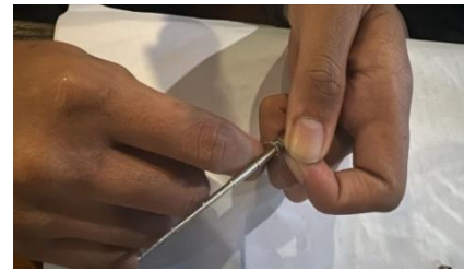
Gambar 1. Pemasangan kawat pada coil jig
