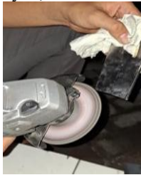
Gambar 2. Proses pengamplasan benda kerja
