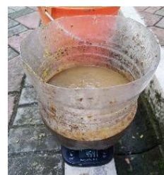
Gambar 10. Sampah tercacah yang melewati saringan dengan ukuran \leq 5 \text{ mm}
