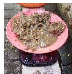
Gambar 11. Sampah tercacah yang tidak melewati saringan dengan ukuran > 5 \text{ mm}
