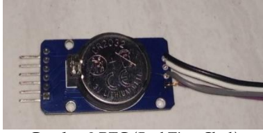
Gambar 2 RTC ( Real Time Clock ) Sumber: Dokumentasi Pribadi
