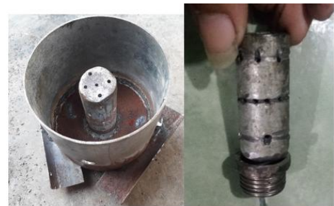
Gambar 3. Gambar ruang bakar dan nozzle kompor (Dokumentasi Pribadi 2025.)
