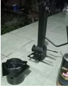
Gambar 5. Proses finishing rangka kompor (Dokumentasi Pribadi 2025.)
