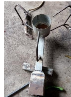
Gambar 4. Proses penyambunagn rangka dan ruang suplay udara kompor (Dokumentasi Pribadi 2025.)
