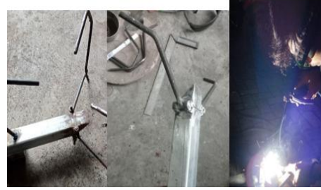
Gambar 2. proses pembuatan rangka dan jalur udara kompor (Dokumentasi Pribadi 2025.)
