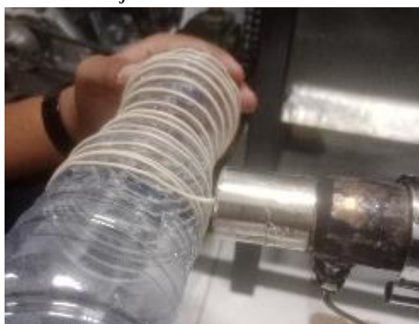
Gambar 11. Hasil Ekstrusi menjadi filamen
