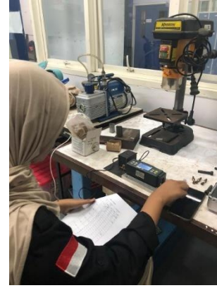
Gambar 2. Proses Pengukuran Kekasaran Permukaan Hasil Pengujian Mur dan Baut Dengan Variasi Kecepatan 1400 Rpm
