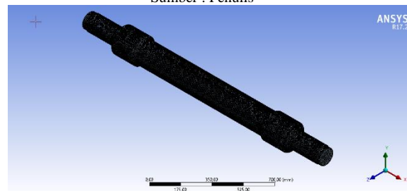
Gambar 4. Mesh 3D Poros Kereta Model B Sumber : Penulis
