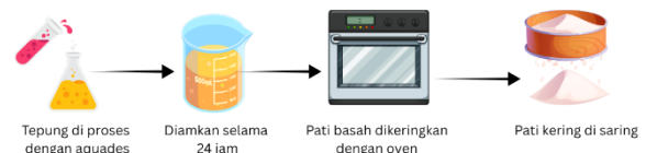
Gambar 1. Proses Sintesis Kulit Singkong (dokumentasi pribadi)
