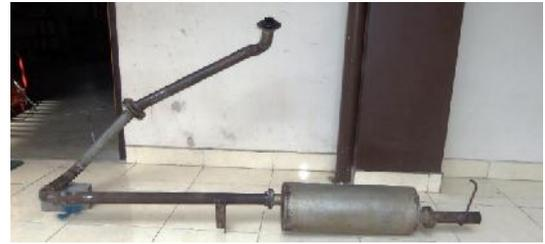
Gambar 2. Knalpot standar *diesel engine stand* Isuzu 190
