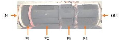
Gambar 20. Penyekat pada *muffler*
