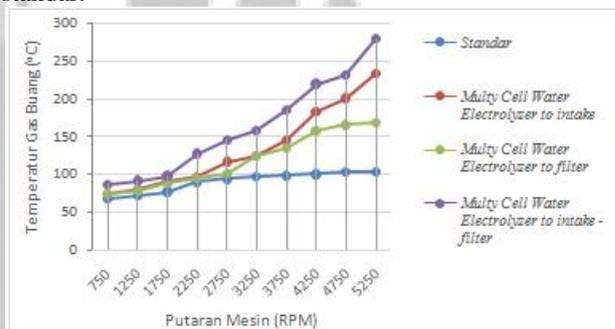
Gambar 11. Hubungan temperatur gas buang (°C) dengan putaran mesin (rpm)
