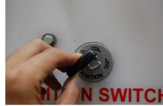
Gambar 26. Menyalakan kunci kontak pada posisi ON
