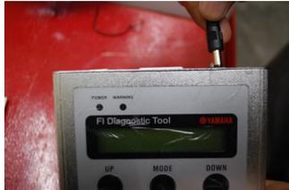
Gambar 22. Memasang kabel *scan tool* 2
