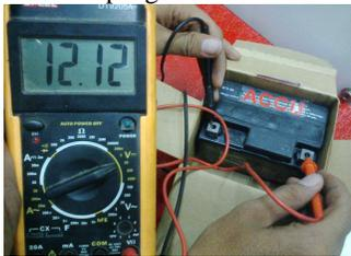
Gambar 2. Mengukur tegangan baterai
