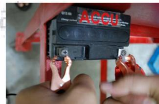
Gambar 20. Menyambungkan sumber tegangan *scan tool* ke *accu*
