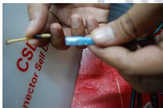
Gambar 25. Menyambungkan konektor CSD dengan *scan tool*
