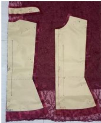
Gambar 11 Proses memotong bahan
