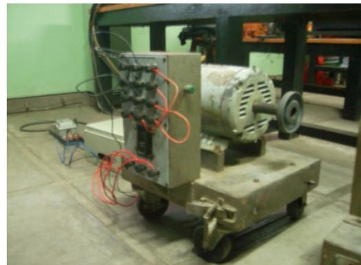
Gambar 7. Motor induksi tiga fasa
