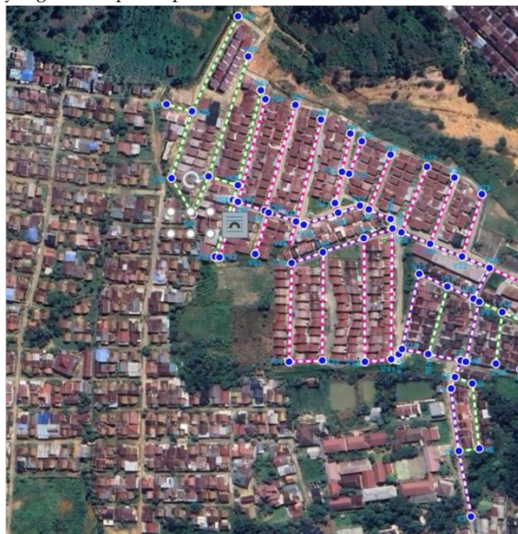
Gambar 20. Penempatan dan Penamaan Titik Jaringan Pipa Tersier yang telah terpasang pada Perumahan Javana City Light (Sumber: Software Peta QGIS , 2024)
