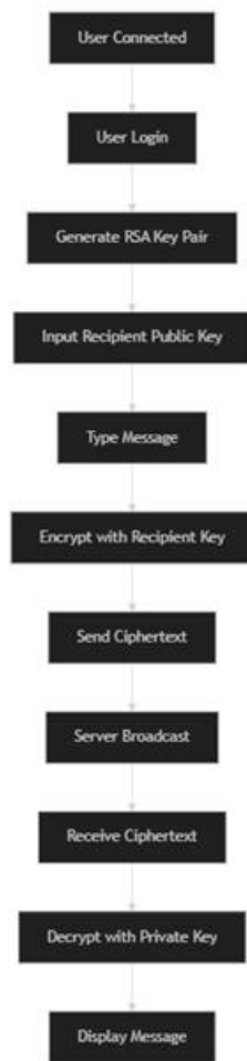
Gambar 1. Flowchart proses enkripsi dan dekripsi pesan pada sistem komunikasi real-time menggunakan algoritma RSA.
