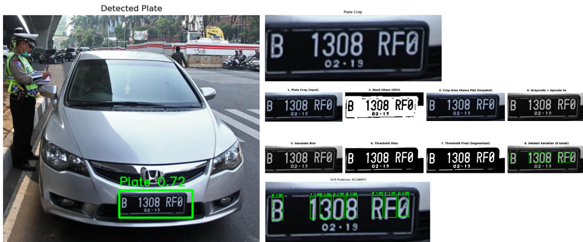
Gambar 10: Contoh hasil pengenalan plat nomor secara end-to-end , mulai dari lokalisasi plat oleh Faster R-CNN, pra-pemrosesan dan segmentasi karakter, hingga keluaran CNN OCR “B1308RF0”.
