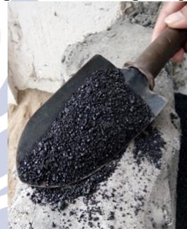
Gambar 2. Copper slag
