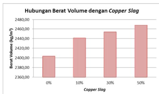
Gambar 7. Hubungan Berat Volume dengan Copper Slag
