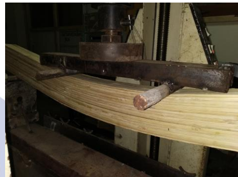
Gambar 4. Pola kerusakan pada titik pembebanan balok
