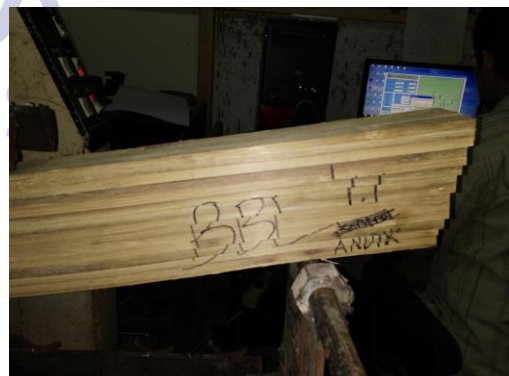
Gambar 5. Kerusakan perekat pada balok bambu petung laminasi
