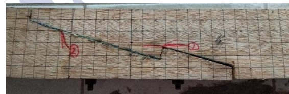
Gambar 12. Kerusakan kayu benda uji D
