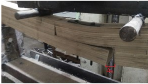
Gambar 4. Pola kerusakan pada titik pembebanan balok
