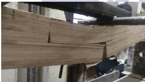
Gambar 5. Kerusakan perekat pada balok bambu petung laminasi
